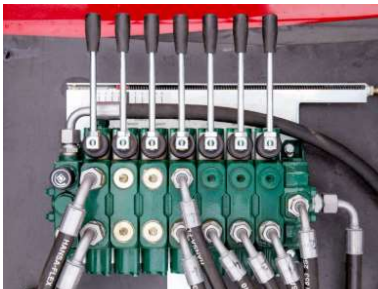
Foto 8 e 9. Controle de comandos hidráulicos da carreta e do braço de colheita
