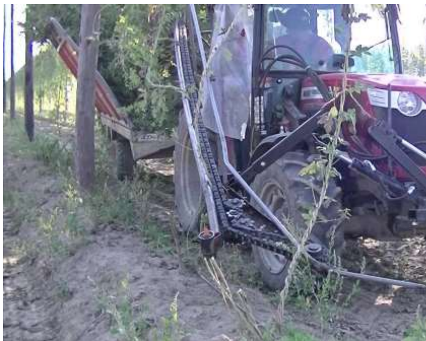
Foto 5: Foto de detalhe de colheita do braço , encaminhando a vinha colhida ao longo de seu braço
