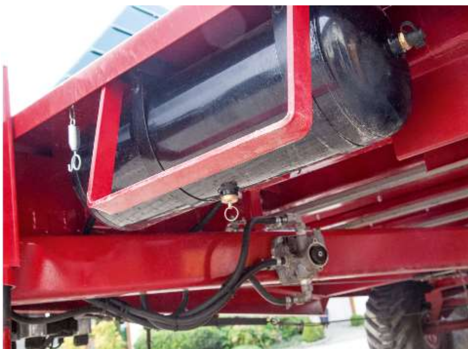
Foto 2. Sistema de acionamento do descarregamento da carreta
