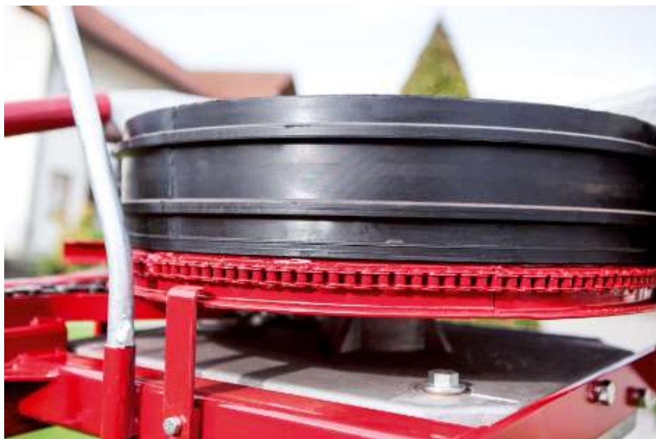
Foto 7. Detalhe de tambor superior, por onde a corrente faz o retorno no braço de colheita
