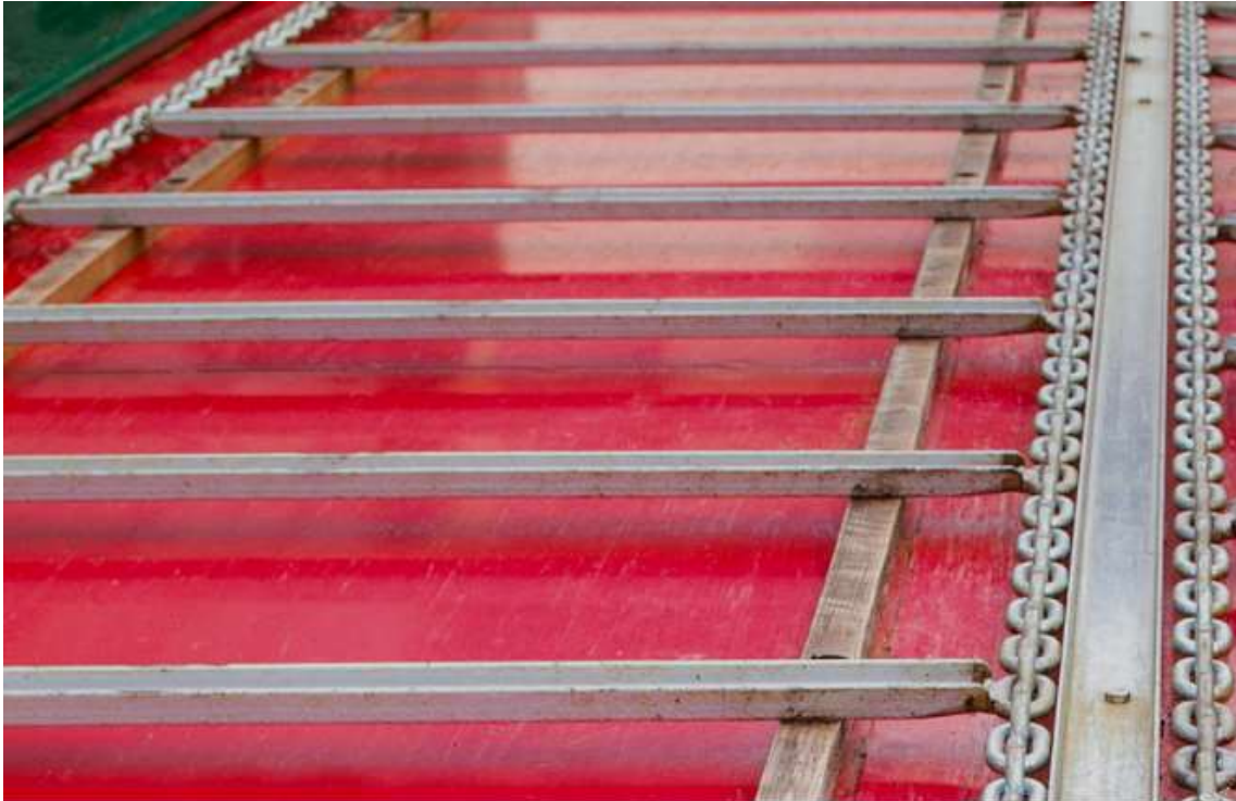
Foto 3. Piso de acionamento hidráulico, para descarregar massa de vinhas colhidas sem desordena-las
