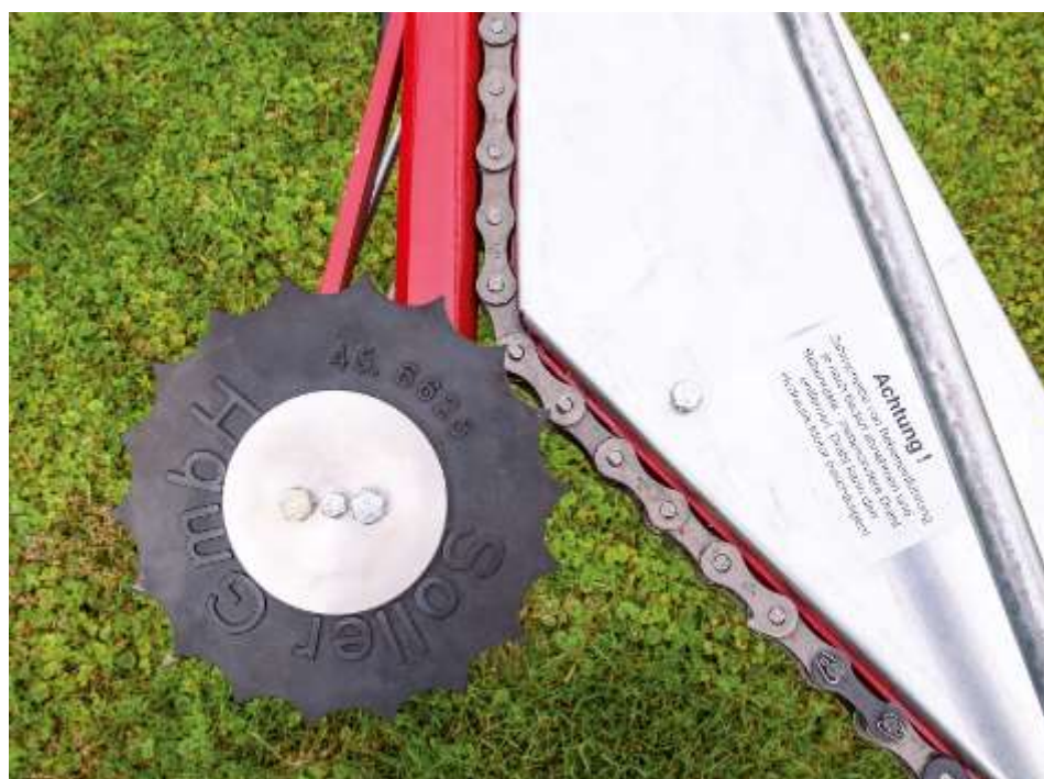
Foto 6. Detalhe de engrenagem que roda corrente de colheita
